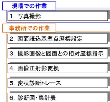
図-2 画像診断システムの手順
